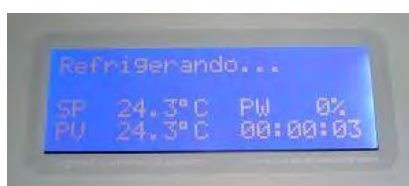
Controlador digital com monitoramento em tempo real da temperatura desejada SP , temperatura real PV , potência do evaporador PW e tempo decorrido
